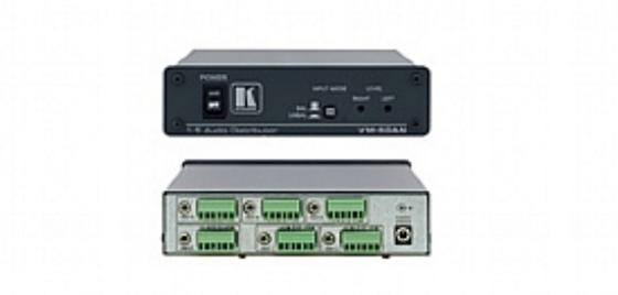
El VM-50AN es un distribuidor amplificador para señales de audio estéreo balanceado y no balanceado. Toma una entrada estéreo balanceado o no balanceado y distribuye la señal simultáneamente a diez salidas estéreo (cinco balanceado y cinco no balanceado).
